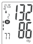
M 2 Messwert aus Speicher 2
